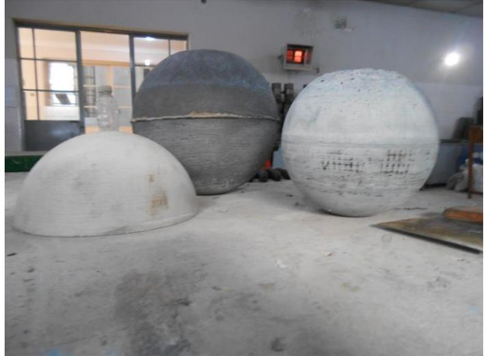
La Práctica consistió en observar la elaboración de un molde de arena de fundición con forma de esfera. Este molde y un molde realizado con impresora 3D con un diámetro menor fueron llenados con mortero autocompactante celeste el cual contenía filler cuarcítico. Además, se compararon terminaciones de la misma mezcla colada en moldes con base de madera, acero o plástico, superficies que fueron tratadas con agente desmoldante y comparadas con superficies sin tratar.
