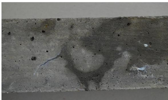
**Fotografía 5:** Geles y fisuración características de las RAS observados en probetas de hormigón reciclado.
