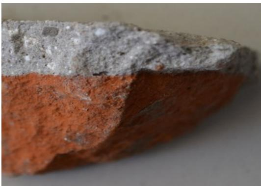
Complementariamente se están realizando ensayos para determinar las características del suelo que se encontró dentro de recinto y se efectúan análisis petrográficos de la arena con la cual está ejecutado el mortero.
